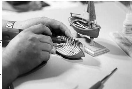
Mit einer kleinen Drahtbürste werden Klebstoffreste entfernt.
