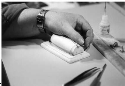
Der erste Spant wird eingesetzt.
