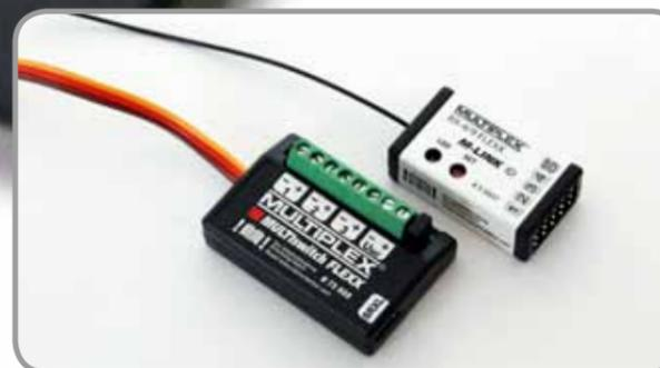
Innovativ sind auch die Zubehör-Produkte. Die zur Smart SX Flexx passenden Empfänger verfügen über das Smart ID-System. Alle Multiplex-Sender, die diese Technologie unterstützen, erkennen den Receiver automatisch und wählen selbstständig den dazugehörigen Modellspeicher aus. Der ebenfalls neu entwickelte Multiswitch-Baustein offeriert neben den serienmäßigen drei zusätzliche Schaltkanäle
